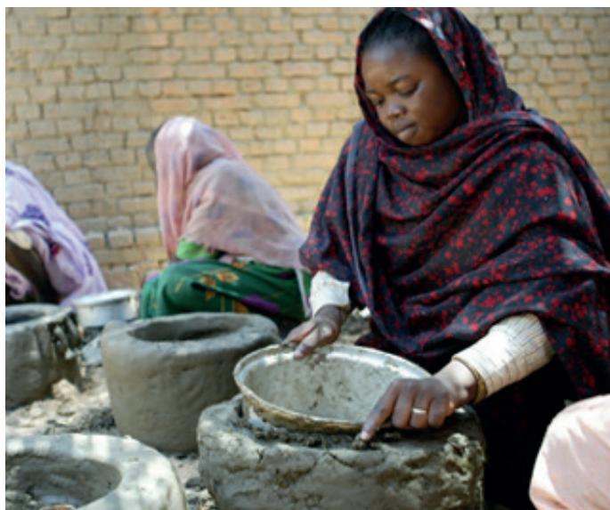
Il s'agit d'un fourneau construit avec de l'argile en utilisant des vieilles boîtes métalliques comme moules.
